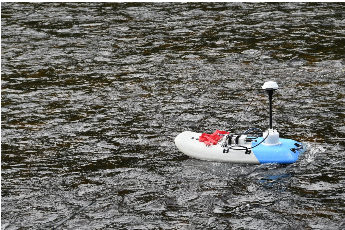
Högteknologisk ADCP-flotte som dokumenterar provlokal i Lögdeälven.
